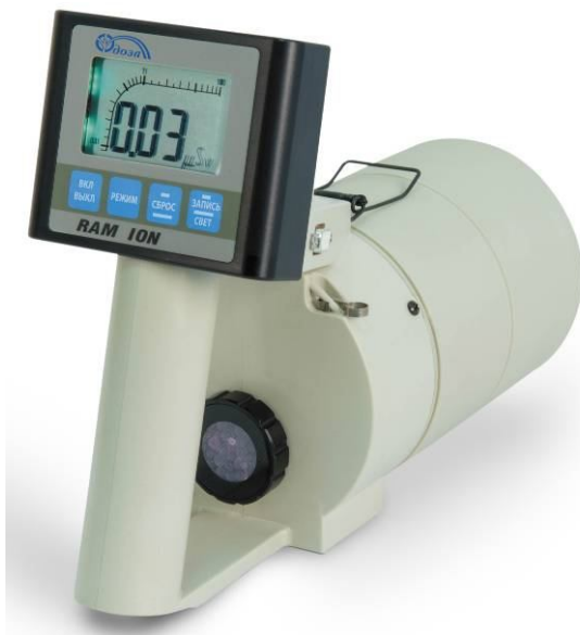
а) для измерений H^*(10) и \dot{H}^*(10) фотонного излучения с энергиями до 3 МэВ
