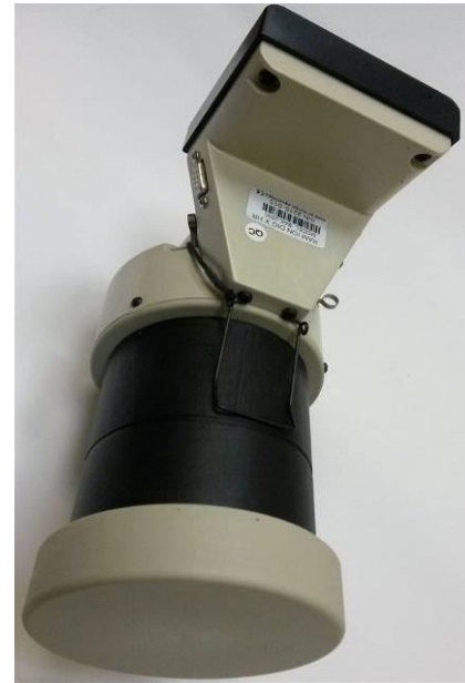
б) для измерений H^*(10) и \dot{H}^*(10) фотонного излучения с энергиями 6 - 10 МэВ
